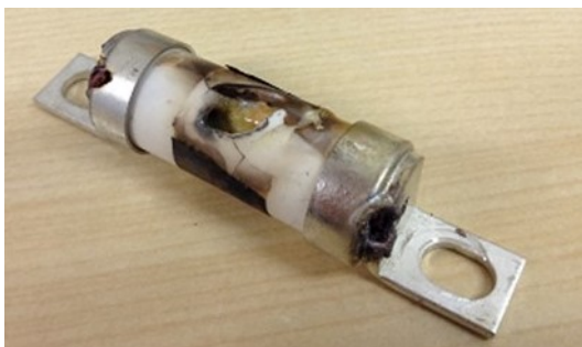
←定格電圧よりも大きい試験電圧で遮断試験を実施し遮断不能となったヒューズ アークを抑制することができず、アーク電流の高熱でキャップと端子まで溶かしてしまい、内部からガスが噴き出し、筒も破損した状態。ガスは、内部のエレメントが高熱で溶解・ガス化した金属ガスです。
